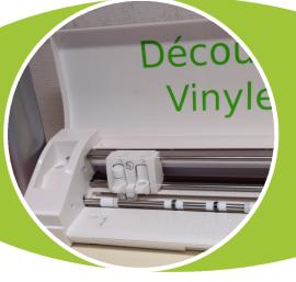
La découpe vinyle est une machine qui permet de découper des matières fines, pour réaliser des stickers, des transferts de tissus...
